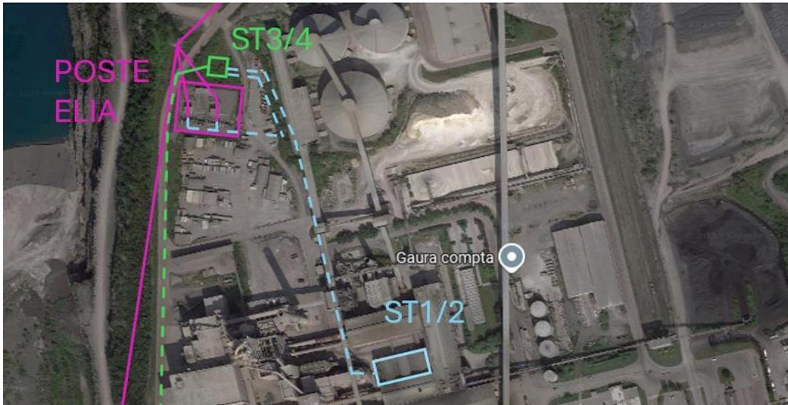
Figure 5 : Tracé du raccordement électrique depuis le transformateur du parc éolien (ST3/4), vers le poste Elia et le réseau de transport ou vers la sous-station de l'usine CCB (ST1/2) (plan fournit par CCB, 2025)
